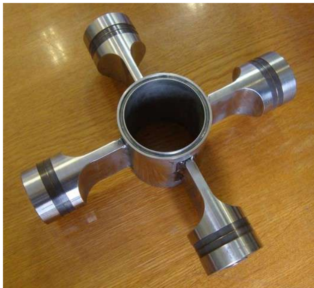
Рис. 8. Модульна ультразвукова кавітаційна секція з трубчастим вібратором
