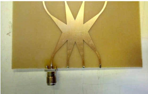
Рис. 22. Під'єднаний SMA роз'єм до першого порта лінзи Ротмана
