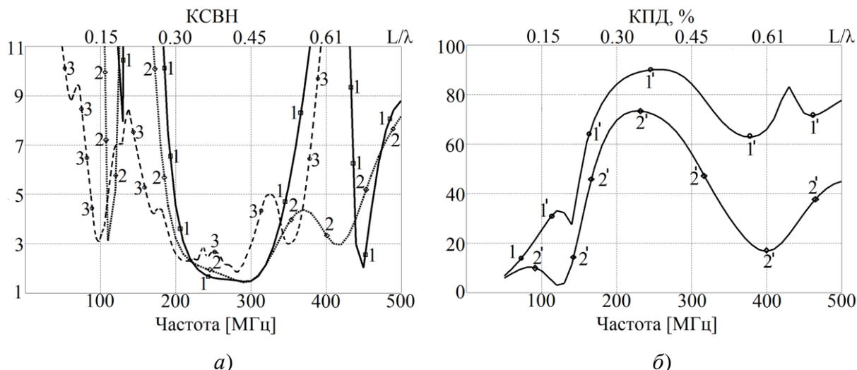
Рис. 4. Расчетные и экспериментальный графики зависимости КСВН (рис. 4,а) и КПД (рис. 4,б) от частоты в исследуемом диапазоне частот: 1,1' — ПА без учёта паров ртути; 2,2' — ПА с учетом влияния паров ртути, 70 мг; 3 — ПА с учетом влияния паров ртути (экспериментальная кривая) при  $\alpha = 90^\circ$ .
