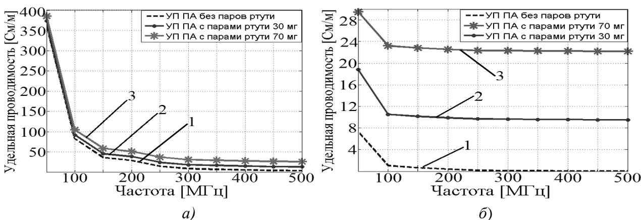
Рис. 2. Графики зависимости УП холодной плазмы от частоты в исследуемом диапазоне частот при эффективной концентрации заряженных частиц  $N_e = 10^{13}$  см<sup>-3</sup> Рис. 2, а. и  $N_e = 10^{12}$  см<sup>-3</sup> Рис. 2, б в ПА с учетом и без учета паров: 1 — без примесей паров ртути, 2 — с примесями паров ртути 30 мг, 3 — с примесями паров ртути 70 мг
