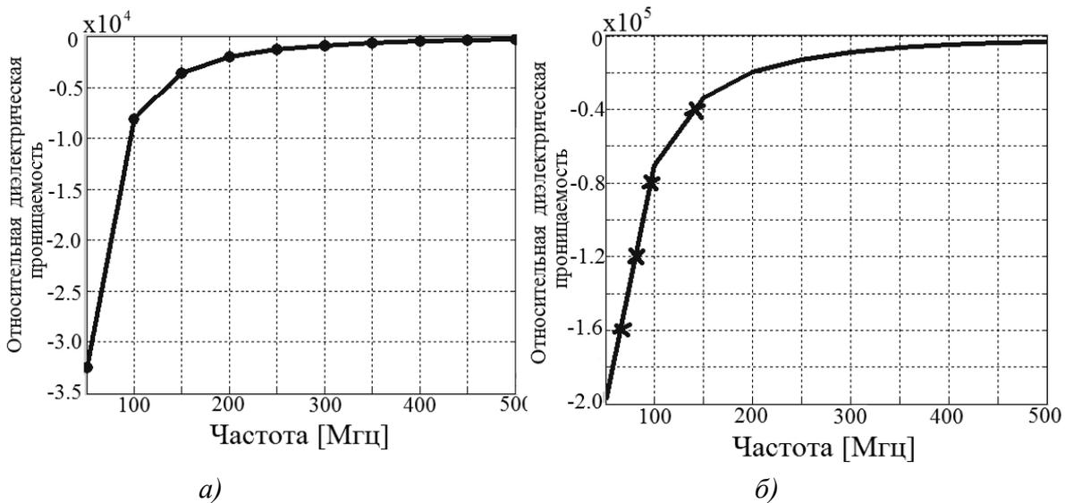
Рис. 3. Графики зависимости ДП холодной плазмы от частоты в исследуемом диапазоне частот при эффективной концентрации заряженных частиц  $N_e=10^{12} \text{ см}^{-3}$  (а) и  $N_e=10^{13} \text{ см}^{-3}$  (б)
