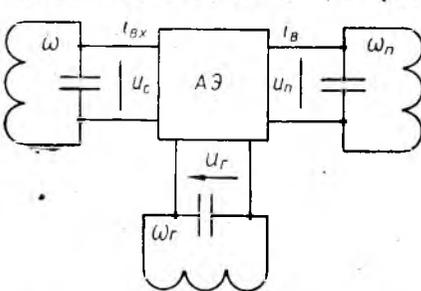
$U_c \ll U_r \gg U_n$ . Разложим выражение для выходного тока  $i_b$  в ряд Тейлора по степеням малых напряжений  $u_c$ ,  $u_n$  и, ограничившись линейным приближением,
